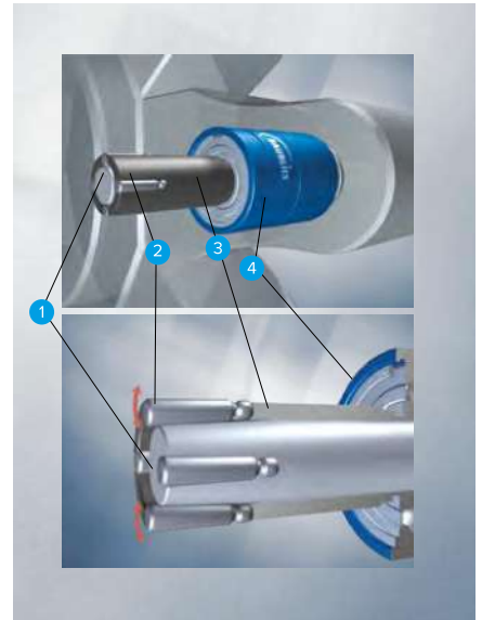
Prinzip eines Planetengetriebes: Der Konus (1) ist fest mit der Werkzeugaufnahme (4) verbunden und der Käfig (3) mit den rotierend gelagerten Rollen (2) frei drehbar.
